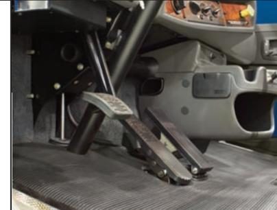
◀ La colocación de los pedales del embrague y acelerador han sido diseñados ergonómicamente de acuerdo a la posición natural del pie, lo que mejora el confort y rendimiento del operador.
